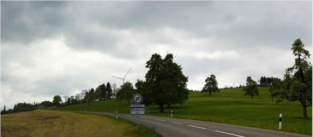
Abb.3: Von der Dorfausfahrt Geltwil Richtung Hitzkirch sind 2 GE 5.3-158 zu sehen. Die Anlagen haben eine Gesamthöhe von 229 m und einen Rotordurchmesser von 158 m. Die nächste Anlage befindet sich 1500 m vom Aufnahmepunkt entfernt.
